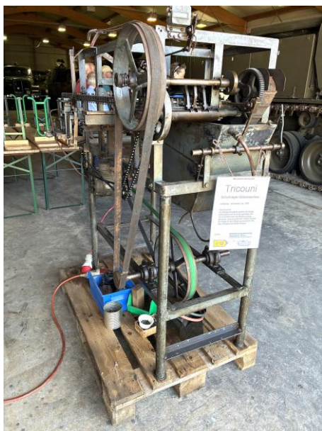
Tricouni: Schuhnagel-Härtemaschine, Herstellung ca. 1935.
