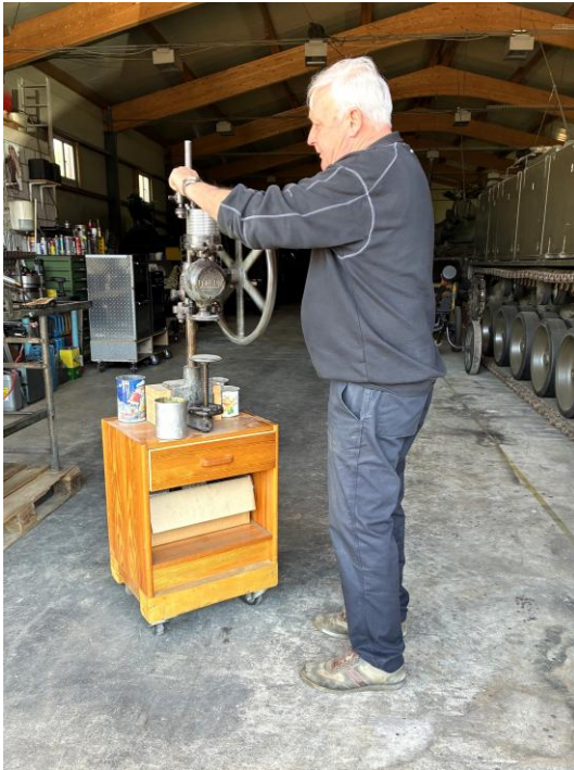
Besitzer Alex Hagenbuch demonstriert eine alte Büchsen-Verschliessmaschine.
