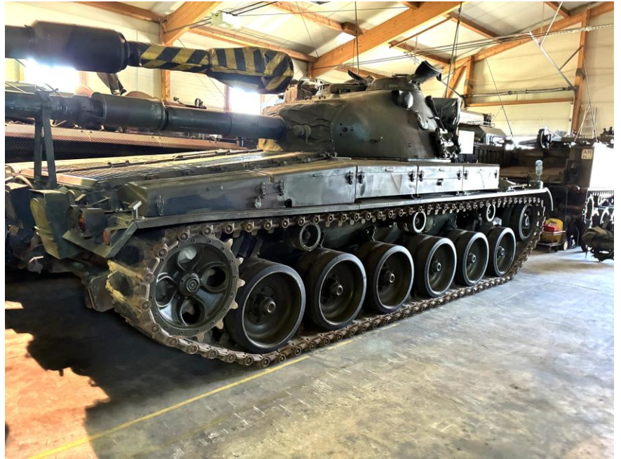
Panzer 68: Gewicht 39,6 t, Reichweite 300 km, mit 10,5 cm stabilisierter Panzerkanone 61.
